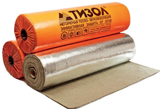
Материал базальтовый огнезащитный рулонный (МБОР), представляет собой слой холста из базальтовых супертонких волокон без связующего, прошитый вязально-прошивным способом с покрывным материалом или без него.
