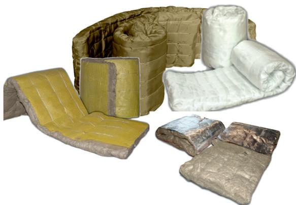
Маты теплоизоляционные прошивные (далее - маты), изготавливаются из холста БСТВ с покрывным материалом или без него и прошиты, в зависимости от марки, стеклянной, базальтовой или кремнеземной нитью в продольном направлении, без использования связующего.
