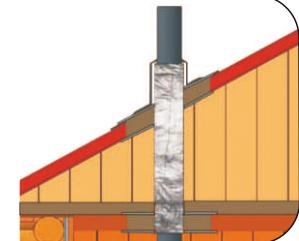
Теплоизоляция и защита от возгорания деревянных стен вблизи печей в банях и саунах.
